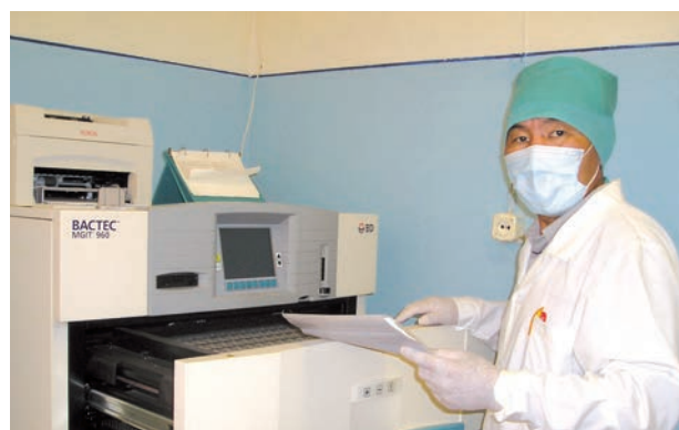
ВАСТЕК MGIT 960 – автоматический микробиологический анализатор для индикации микобактерий туберкулеза и лекарственной чувствительности к противотуберкулезным препаратам основного ряда анализ проводит с.н.с. Павлов Н.Г.
