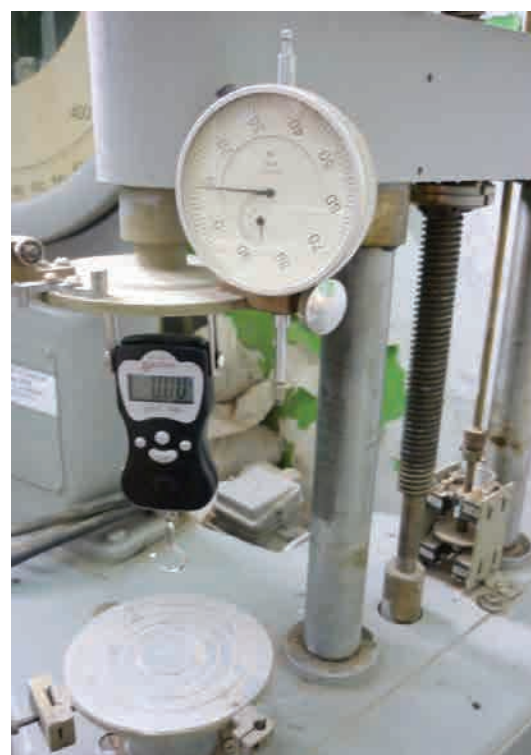
Рис. 3. Граммметр «Весна», модель OCS-20A
